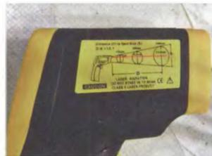
**Угол замера.** Чем дальше прибор от объекта, температура, которого нас интересует, тем от большего по площади круга он замеряет тепловое излучение. Соотношение 12 к 1. То есть с 12 метров мы замеряем излучение от круга диаметром в 1 м. Или угол замера около 7 градусов.
