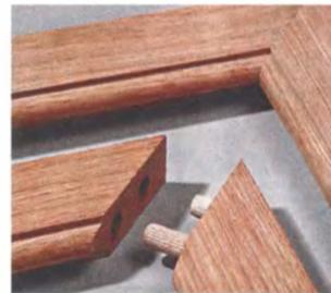
Угловое клеевое соединение «на ус» деталей рамы усилено двумя деревянными шкантами. Собранный раму на время сушки клея стягивают ремнями.
