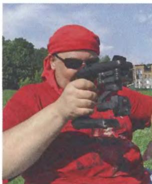
Перед полётом Константин демонстрирует работу стедигрипа, автономного пульта управления подвесом, на котором установлена экиш-камера. С помощью него можно снимать видео «с руки», без использования квадрокоптера, камера стабилизируется в пространстве. С таким устройством удобно снимать видеобзор с выставки или вечеринки.
