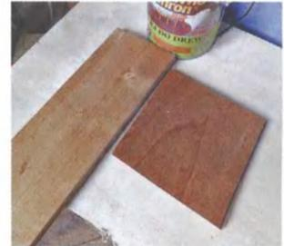
Обрезок вагонки и кусок нешлифованной фанеры покрыты одним слоем «Тиковой» пропитки. Поверхность фанеры более шероховатая, из-за этого цвет получился более темный и насыщенный.
