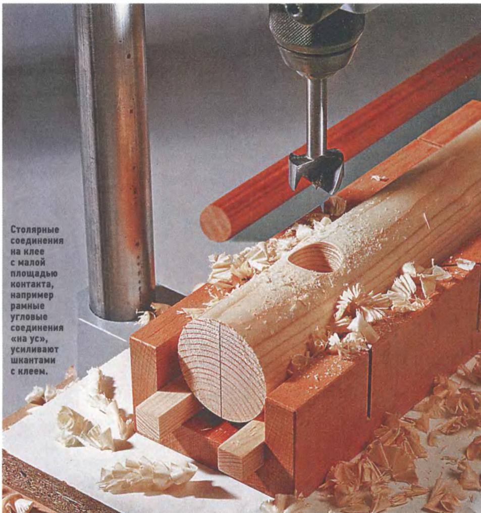
Столярные соединения на клею с малой площадью контакта, например рамные угловые соединения «на ус», усиливают шкантами с клеем.
