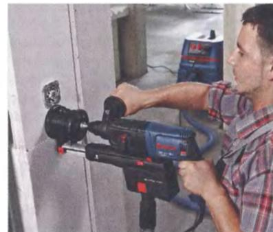
Многие перфораторы имеют специальные приспособления для подключения и пылесосу. Приспособление, показанное на фото, служит одновременно и ограничителем глубины сверления.
