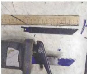
Принцип работы пилы как у электролобзика. Надо как следует упереться упором, например в бревно, запустить пилу, полотно начинает ходить с частотой 3000 об/мин, с амплитудой 22 мм.
