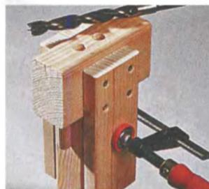
Просверлить отверстия в торцах обычным спиральным сверлом можно, только используя сверильную стойку или с помощью небольшого самодельного кондуктора.
