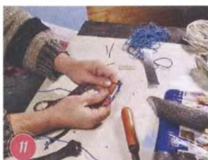
11 На всякий случай над узлом обжариваем концы шнура полоской из оцинковки.
