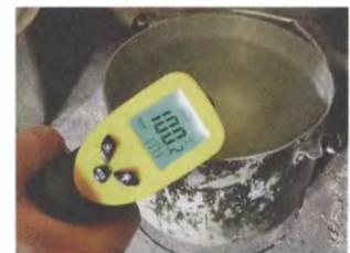
На печке начала закипать вода, термометр показал почти 100 °С. На основании замера делаем вывод, что прибор показывает реальную температуру.
