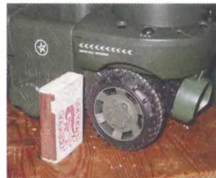
Диаметр колеса — 5 см. Реально амфибия может преодолеть препятствие высотой 2,5–3 см.
