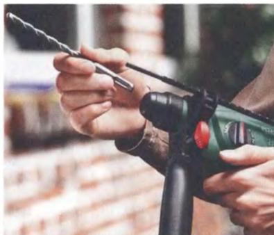
Ограничитель глубины обычно устанавливается на съёмной ручке инструмента.
