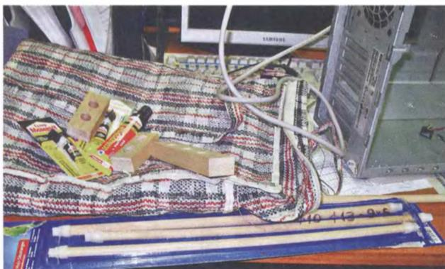
Теперь переходим к механической части. Колбасу надо на что-то подвесить. В зоомагазине попались палки для птичек, которые идеально подошли по длине. Под них распилили на чурбачки буквовую рейку и просверлили отверстия под зоопалки.
