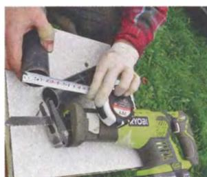
Для теста попробовал распилить стальную трубу диаметром 40 мм. Тоже проблем не возникло. По времени чуть дольше, чем резать такую трубу «болгаркой».
