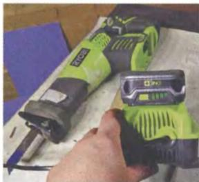
**Сзади на аккумуляторе находится индикатор заряда. Нажал кнопку, светодиодный индикатор показал заряд. Время заряда аккумулятора 45–60 мин.**
