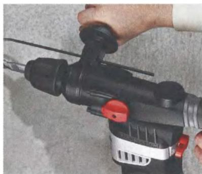
Поперечное расположение электродвигателя на перфораторе позволяет снизить вибрацию.
