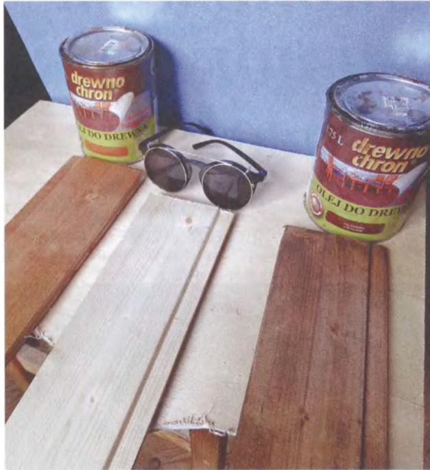
Тестовые обрезки вагонки покрыты одним слоем масла. Покрывалась вагонка без зашкуривания поверхности. Слева цвет «Тик», справа «Палисандр».
