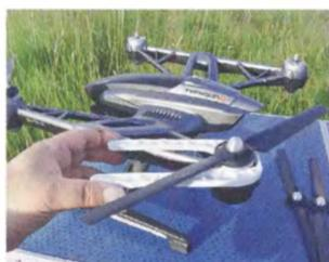
**Typhoon G** — это не комнатный вариант квадрокоптера! Расстояние между двигателями 40 см. Винты большие — 33 см. Приличные размеры позволяют ему уверенно держаться в воздухе и противостоять порывам ветра.
