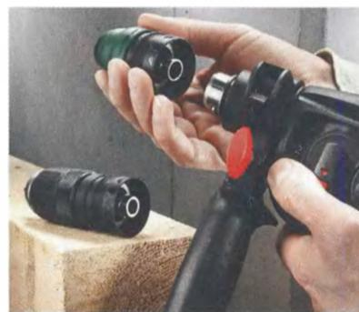
Патрон SDS-Plus на некоторых моделях легко устанавливается и снимается при необходимости его замены на другой патрон (например, под цилиндрические хвостовики).
