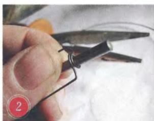
На сверло диаметром 5 мм наматываем полтора оборота проволоки. Надо постараться, чтобы витки плотнее прилегли друг к другу.
