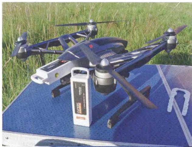
Аккумуляторы 3S 5400 мАч в жёстком корпусе. Два аккумулятора в комплекте. Защиты от не оригинальных аккумуляторов нет, так что можно использовать и самодельные варианты.
