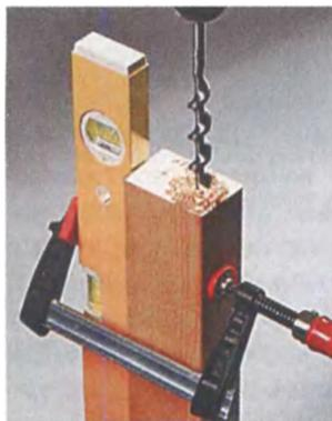
Сверлить отверстия в торцах деталей можно только винтовым сверлом, закреплённым в ручной дрели. Оно имеет специальную спираль, которая при вращении сверла затягивает его в материал.
