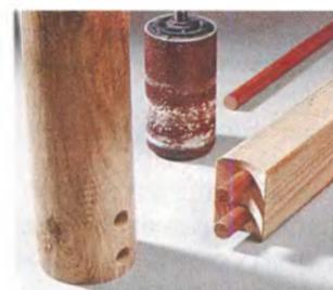
При соединении на шкантах круглых ножек с прямоугольными царгами торцы последних следует сделать вогнутыми в соответствии с контуром ножек, например с помощью шлифовального валика. Но сначала в них надо просверлить отверстия под шканты.
